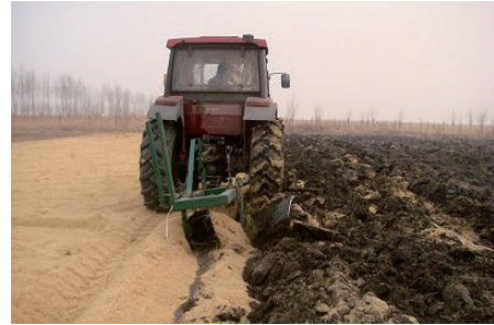
図 3 プラウによるもみ殻埋設作業 （撮影：2009 年 11 月 15 日）
